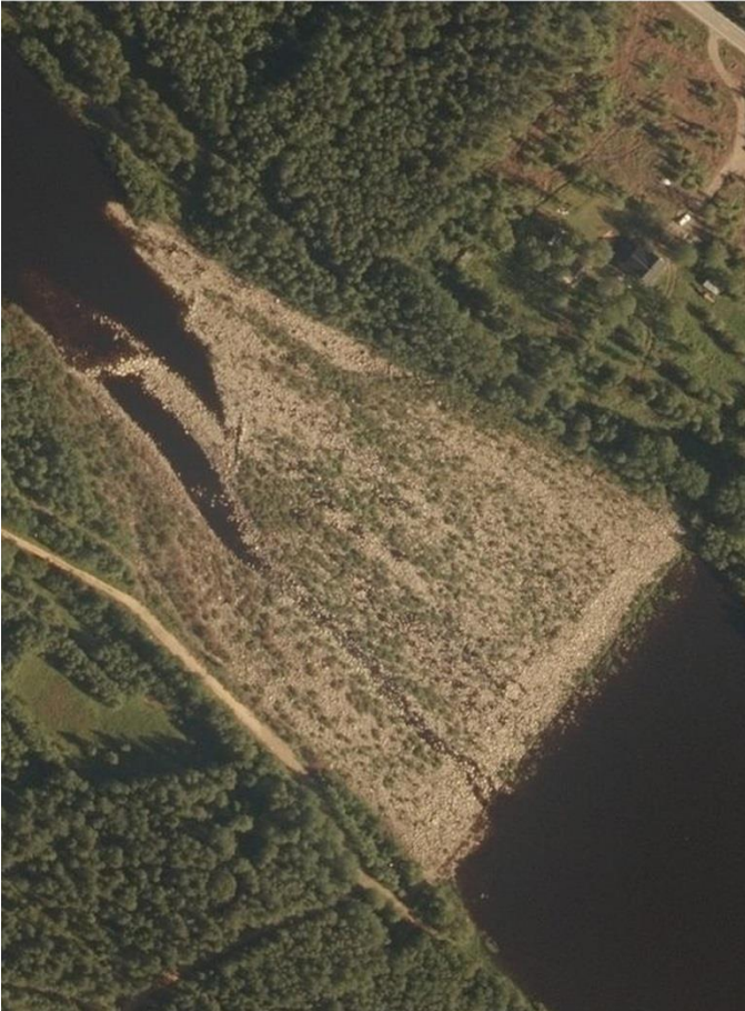
Kuva 3. Ilmakuvaesimerkit Raasakan vanhan haaran pohjapadoista. Ylemmässä kuvassa on Merikosken pohjapato (4), jossa näkyvät rannoille tehtyt vesiväylät. Alemmassa kuvassa on Uiskarinhaaran pohjapato(6), jonka yksittäinen kalatieuoma alaneljänneksellä on kuivana veden ohjautuessa normaalisti Illinhaaraan. Kuvat on tulostettu Paikkatietoikkunasta 25.6.2016.
